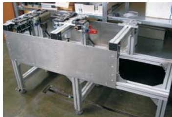
Fot. 4. Magazyny narzędzi: a) robota Reinoldus, b) robota KUKA
