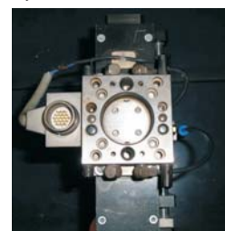
Fot. 3. Uchwyty narzędziowe (sprzęgi): a) robota, b) narzędzia
