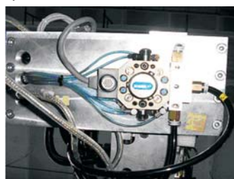
Fot. 3. Uchwyty narzędziowe (sprzęgi): a) robota, b) narzędzia
