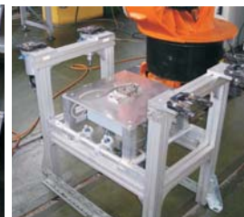
Fot. 4. Magazyny narzędzi: a) robota Reinoldus, b) robota KUKA
