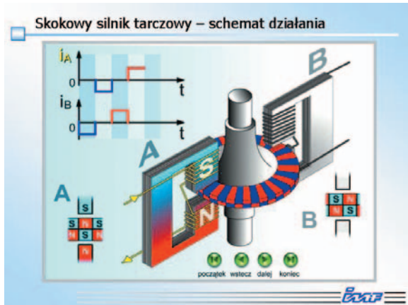
Rys. 7. Jedna z przykładowych animacji do wykładu, ilustrująca schemat budowy, a następnie zasadę działania skokowego silnika tarczowego
