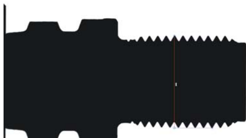
▲ Fot. 4. Pomiar średnicy zewnętrznej gwintu na metalowym korpusie
