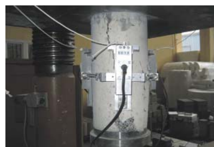
Tensometryczny czujnik przemieszczeń umieszczony na zniszczonej próbce
