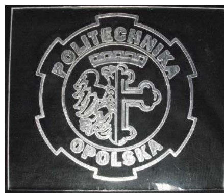
Rys. 4. Logo Politechniki Opolskiej wyfrezowane w płycie z poliwęglanu – efekt końcowy działania programu DXFPlot
