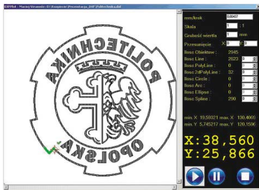
Rys. 3. Interfejs graficzny programu DXFPlot (linie zielone pokazują część wyfrezowaną)
