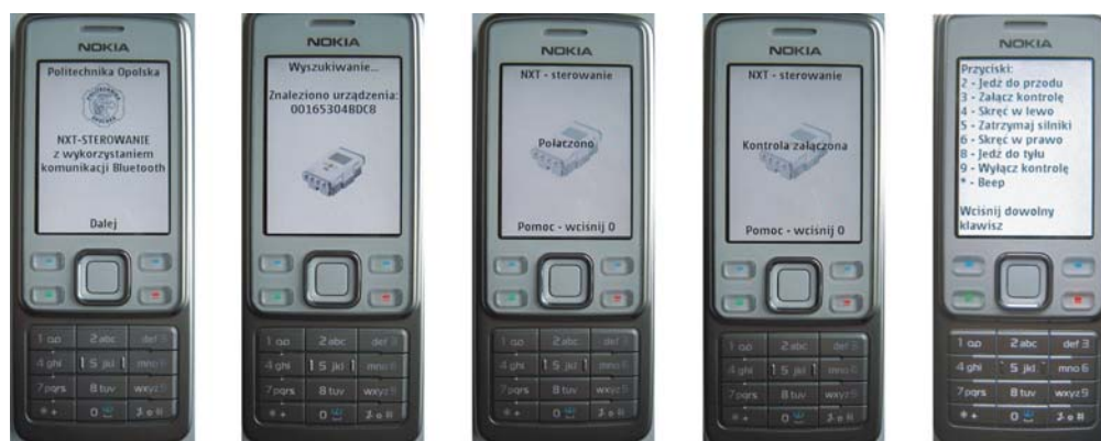
Rys. 7. Ekran telefonu komórkowego podczas wyszukiwania robota LEGO, nawiązywania z nim połączenia i sterowania oraz ekran z pomocą
