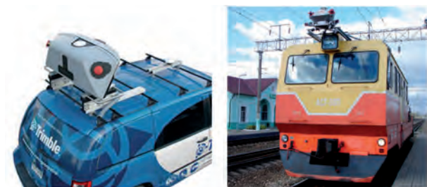
a) Trimble MX8 zamontowany na dachu samochodu [8]
