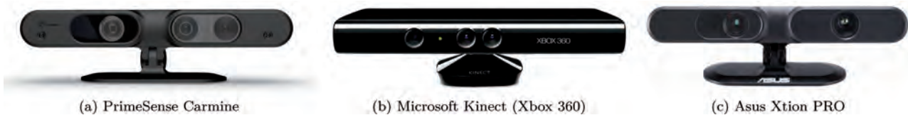
Rys. 2. Czujniki zwracające obrazy RGB-D bazujące na technologii opracowanej przez PrimeSense
