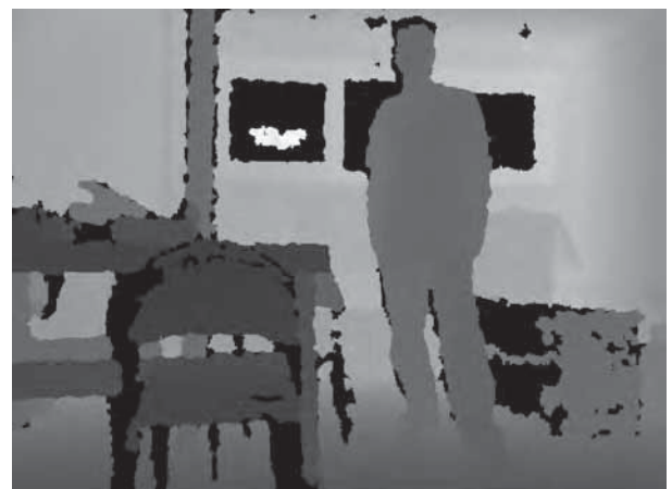
Rys. 1. Mapa głębi uzyskana bezpośrednio z urządzenia obrazującego (Kinect); jasność oznacza odległość punktu od kamery – im jaśniejszy, tym punkt znajduje się dalej, punkty całkowicie czarne oznaczają brak odczytu
