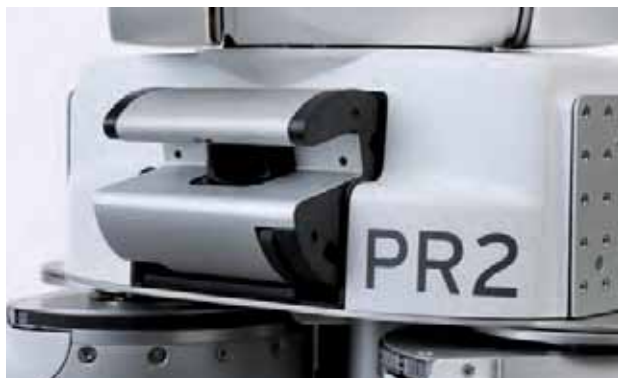
Rys. 11. Ruchomy skaner laserowy zamontowany na głowicy uchylniej w szyi robota PR2
