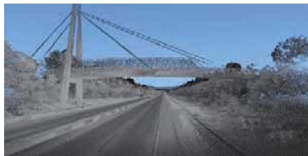
Rys. 3. Chmura punktów zintegrowana z kilkudziesięciu odczytów laserowych [www.igi.eu]
