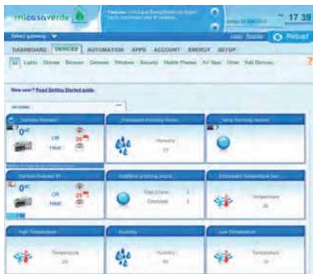
Rys. 3. Przykład ekranu kontrolnego centralki Vera3 Fig. 3. Example view of control screen of Vera3 controller
