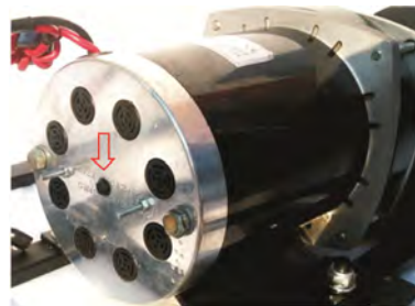
Rys. 10. Widok zamontowanego magnesu
