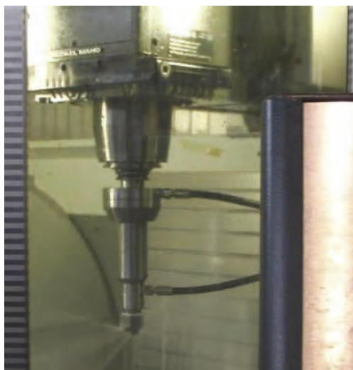
Rys. 6. Widok gotowego do pracy narzędzia nagniatającego zamontowanego na obrabiarce CNC
