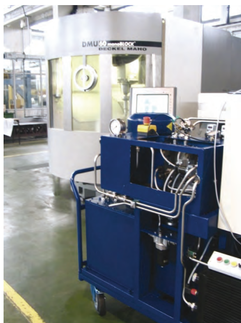
Rys. 7. Widok zasilacza hydraulicznego i centrum CNC podczas prób rozruchowych
