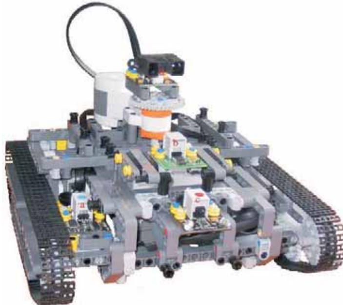
Rys. 4. Widok ogólny robota, z zaznaczeniem poszczególnych sensorów: a – kompas cyfrowy, b – akcelerometr (pomiar w dwóch wymiarach), c – detektor przeszkód, d – dalmierz, umieszczony na osi silnika
