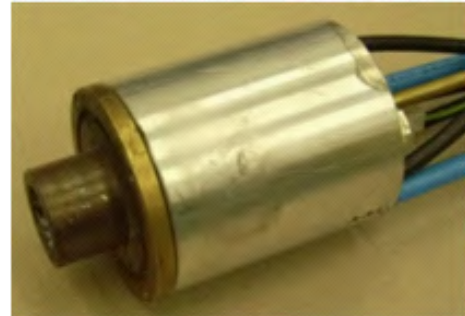
Rys. 1. Plazmotron łukowy o mocy 50 kW z doprowadzonymi przewodami zasilającymi (konstrukcja własna)
