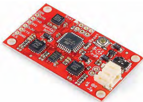
Rys. 7. Wykorzystany moduł inercyjny
