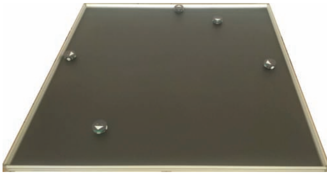
Rys. 1. Stół z umieszczonymi na nim robotami mobilnymi Fig. 1. Test bench with mobile robots placed on it
