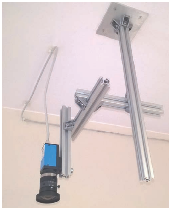
Rys. 3. Kamera DFK23GP031 wykorzystana do akwizycji obrazu Fig. 3. DFK23GP031 camera used for image acquisition
