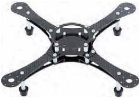
Rys. 2. Widok ramy pojazdu [5]
