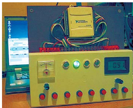
Rys. 5. Stanowisko laboratoryjno-dydaktyczne z kartą NI-DAQ USB 6008 i pakietem CPDev
