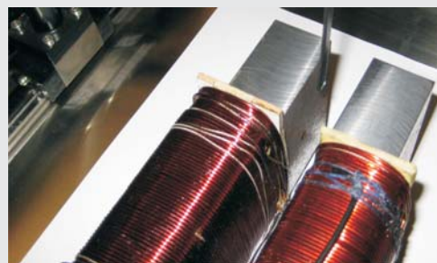
Rys. 7. Skanowanie pola siłownika EM-C-90-1200-AP04
