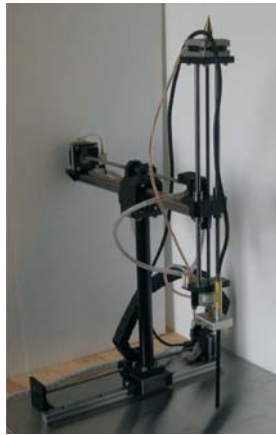
Rys. 2. Zrobotyzowane stanowisko badawcze pola magnetycznego
