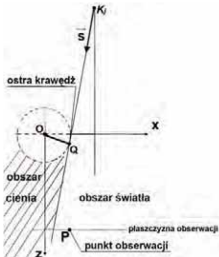
Rys. 2. Układ dyfrakcyjny dla przypadku źródła punktowego i ostrej krawędzi
