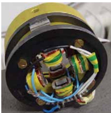
Rys. 4. Aktywne heteropolarne promieniowe łożysko magnetyczne opracowane i wykonane w WAT [1]
