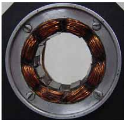
Rys. 2. Aktywne heteropolarne łożysko magnetyczne opracowane i wykonane w WAT [1]
