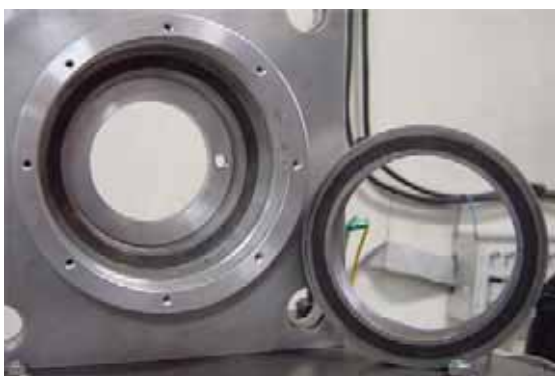
Rys. 3. Aktywne heteropolarne osiowe łożysko magnetyczne opracowane i wykonane w WAT [3]
