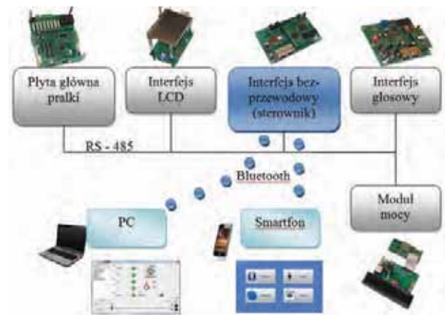
Rys. 5. Budowa modułowego sterownika pralki
