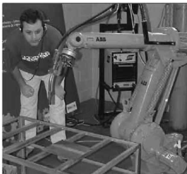
Rys. 2. Robot przemysłowy sterowany komendami głosowymi [6] Fig. 2. Industrial robot controlled by voice commands [6]
