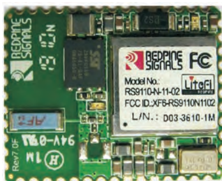
Rys. 2. Zdjęcie wybranego do projektu modemu WiFi oraz rozmieszczenie i opis wyprowadzeń układu Redpine Signals – RS9110-N-11-22
