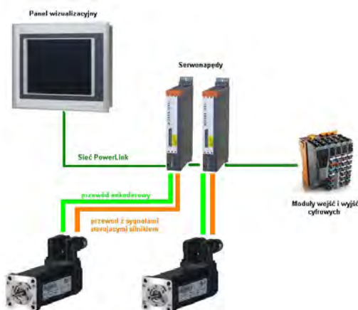
Rys. 3. Schemat blokowy systemu sterowania Fig. 3. Block diagram of control system
