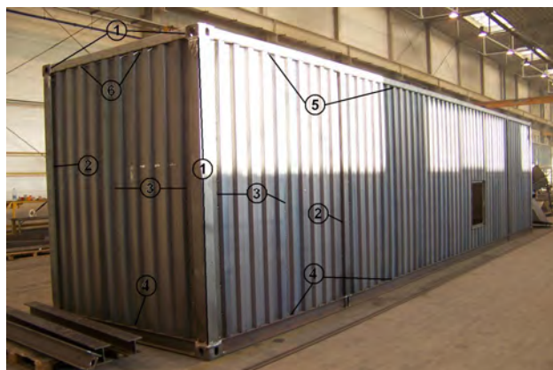
Rys. 3. Kontener z zaznaczonymi charakterystycznymi punktami, w których występują problemy
