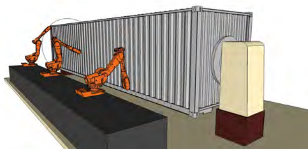
Rys. 1. Zakładany schemat procesu spawania Fig. 1. Assumed of the welding process diagram
