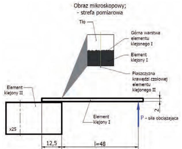
Rys. 4. Ukazanie koncepcji pomiaru odkształcenia
