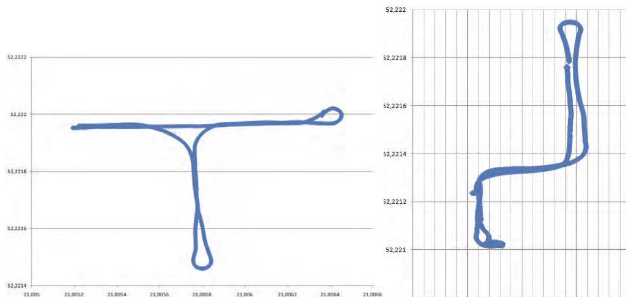
Rys. 7. Wyniki uzyskane ze układu nawigacyjnego w trakcie autonomicznego przejazdu po wyznaczonej trasie
