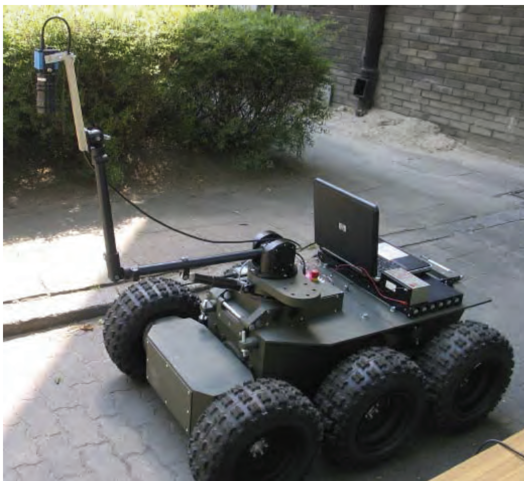
Rys. 6. Badania pojazdu zbudowanego na bazie robota IBIS z systemem nawigacji wizyjnej
