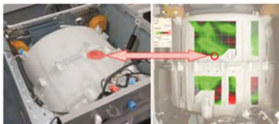
Rys. 9. Badany bęben pralki oraz przykładowa klatka z obrazu wibracyjnego wraz z zaznaczonym wybranym punktem pomiarowym do badań porównujących
