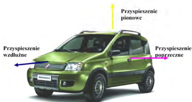
Rys. 5. Układ współrzędnych przy opisie ruchów pojazdu Fig. 5. Car motion description by the usage of co-ordinate system
