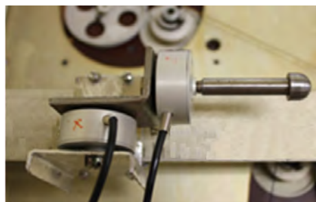
Rys. 3. Dwuosiowy czujnik siły
