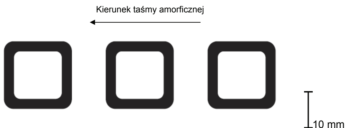
Rys. 1. Matryce do fotolitograficznej produkcji rdzeni ramkowych ze stopów amorficznych
