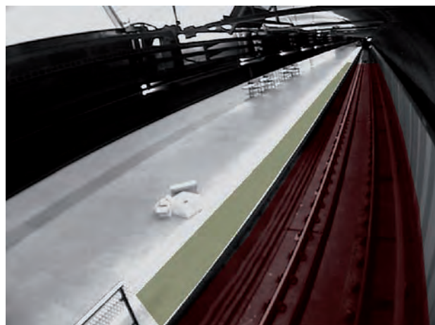
Rys. 4. Widok z kamery z zaznaczonymi dwiema różnymi strefami detekcji
