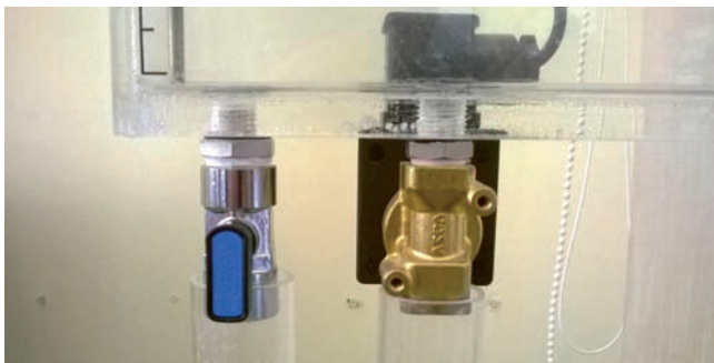
Rys. 4. Para zaworów – ręczny (lewy), sterowany (prawy) Fig. 4. Pair of valves – manual (left), controllable (right)
