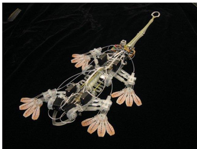
Fig. 2. Climbing robot with sticky feet inspired by Gecko lizard [1] Rys. 2. Robot wspinający się za pomocą przyssawek wzorowanych na łapkach gekona [1]
