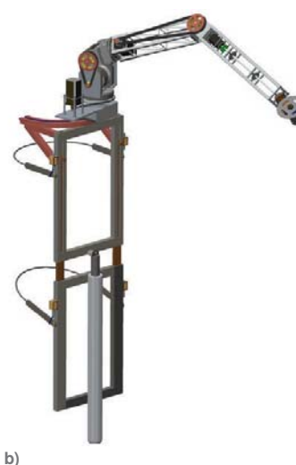
Fig. 8. a) Links 1 and 2 occupied with motors in them, b) Full robot assembly Rys. 8. a) Człony 1 i 2 z zabudowanymi w nich silnikami, b) widok całościowy zmontowanego robota
