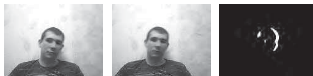
Rys. 6. Metoda bazująca na różnicy obrazów Fig. 6. Method based on the images differences
