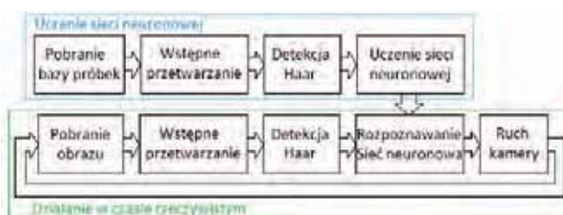
Rys. 7. Ogólny schemat przepływu informacji Fig. 7. General flowchart of the data processing
