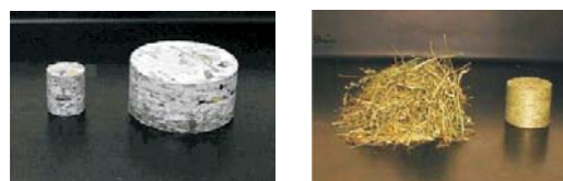
Rys. 5. Kapsuły uformowane z zagęszczonego materiału transportowanego [www.freightpipelinecompany.com]
