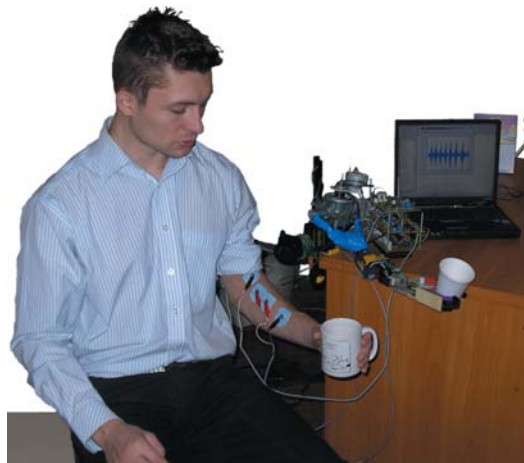
Rys. 7. Wykorzystanie miopotencjałów z trzech różnych mięśni do sterowania manipulatorem ręki
