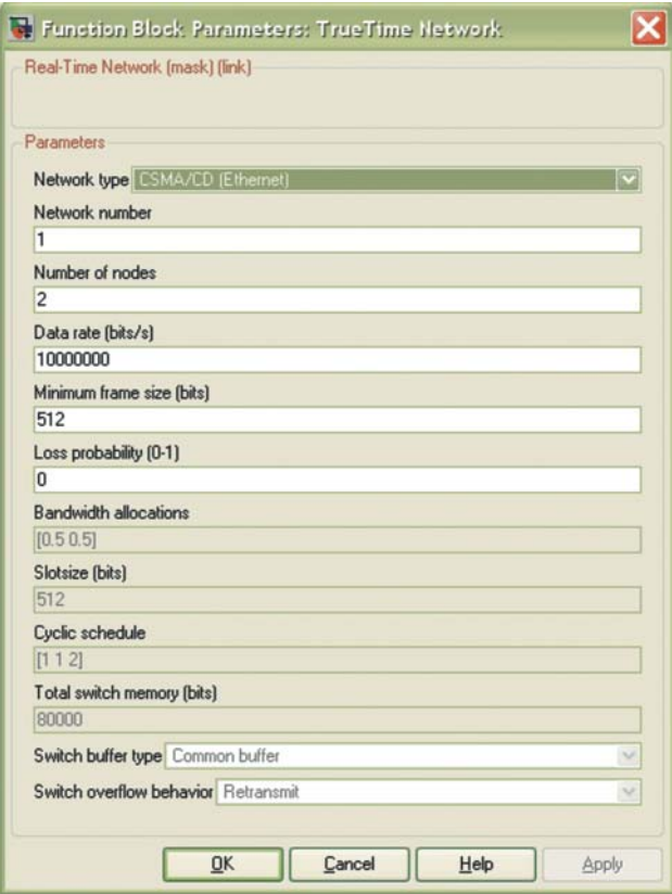
Rys. 5. Przykładowe okno konfiguracyjne bloku TrueTime Network [5]
