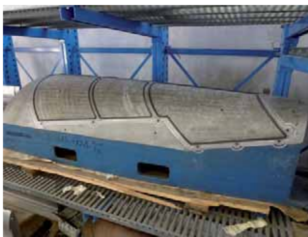
Rys. 1. Typowa forma mocująca stosowana w zakładach Piaggio Aero
