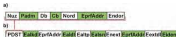
Rys. 4. Struktura: a) podstawowych danych diagnostycznych przetwornic częstotliwości, b) rozszerzonych danych diagnostycznych, gdzie: Nuz – nazwa użytkownika, Padm – poziom uprawnień, Db – data, Cb – czas bieżący, Nord – numer porządkowy stacji SLAVE, EprfAddr – błąd adresu sieciowego, Endor – błąd numeru porządkowego stacji SLAVE, Ealkd – kod alarmu, Ealld – długość informacji alarmowej, Ealtp – typ alarmu, Ealsn – numer gniazda stacji SLAVE, Enext – numer rozszerzonej informacji diagnostycznej, Eextdl – długość danych rozszerzonej informacji diagnostycznej, Eiden – numer identyfikacyjny jednostki SLAVE
