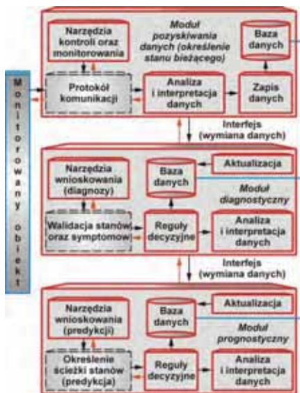
Rys. 1. Schemat zależności poszczególnych modułów funkcjonalnych oprogramowania opracowanego na bazie założeń proponowanej metody
