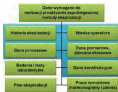
Rys. 5. Podstawowe elementy wymagane w fazie budowy modelu prognostycznego, bazujące na diagnostycznych metodach pozyskiwania informacji
