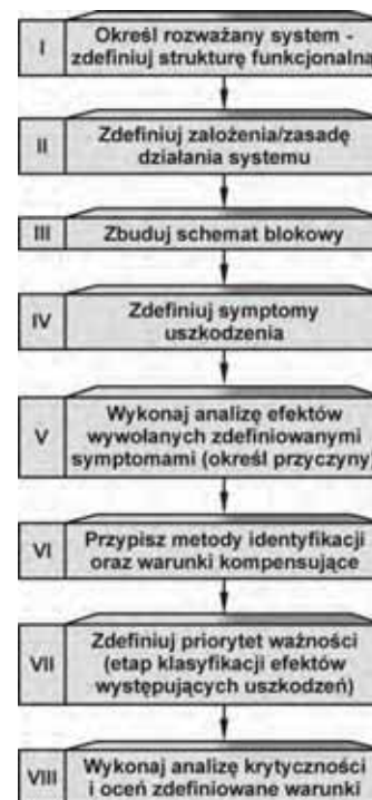
Rys. 1. wSchemat metodologii FMECA
