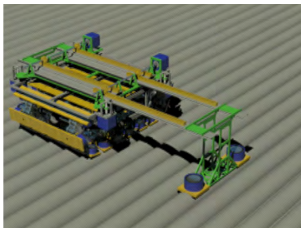
Rys. 12. Druga faza ruchu poprzecznego – opuszczenie ramy górnej
