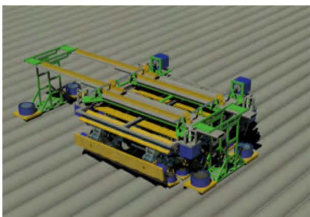
Rys.14. Czwarta faza ruchu poprzecznego – opuszczenie modułu głównego i podniesienie ramy górnej
