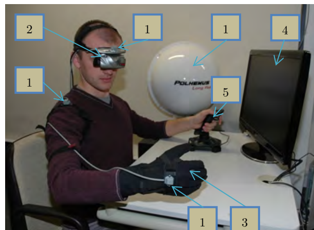
Rys. 7. Interfejs sterowania. 1 – magnetyczny system śledzenia, 2 – info-hełm, 3 – info-rękawica, 4 – monitor 3D, 5 – joystick
