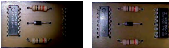
Rys. 6. Przykłady błędnego oświetlenia płytki przy oświetleniu punktowym
