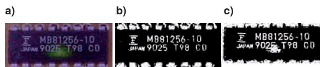
Rys. 7. Odblask światła na zdjęciu kolorowym (a); binaryzacja RGB (b); binaryzacja koloru niebieskiego (c)
