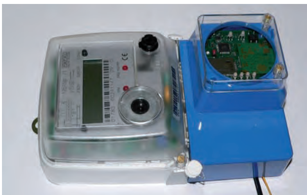
Rys. 5b. Koncentrator danych odczytowych zamontowany w liczniku
