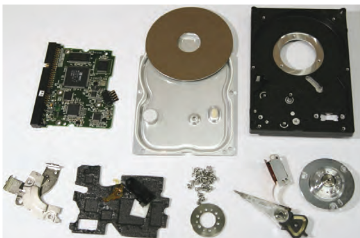
Fot. 2. Wydzielone podzespoły dysku po pełnym demontażu
