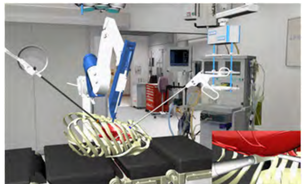
Rys. 5. Model operacji na sercu z robotem Robin Heart Vision – wirtualna sala operacyjna. Sala została wyposażona we wszystkie projektowane roboty, narzędzia mechatroniczne oraz wybrane typowe narzędzia chirurgiczne i elementy sali operacyjnej. Technologia wirtualnej rzeczywistości może doskonale służyć jako interaktywne narzędzie szkoleniowe Fig. 5 Model of prepared operation with Robin Heart Vision in the environment of surgical room with all important elements included
