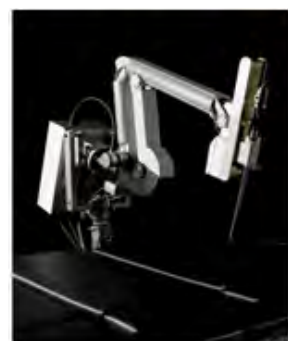
Rys. 3. Robin Heart Vision – robot toru wizyjnego do operacji małoinwazyjnych Fig. 3. Robin Heart Vision: telemanipulator for vision channel control in MIS
