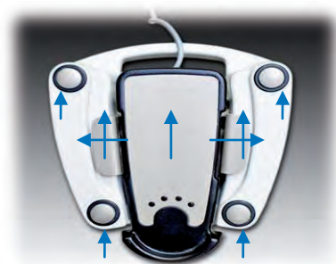
Rys. 7. Nowe zadajniki Master dla manipulacji ramieniem (góra) i zadajnik nożny (dół)
