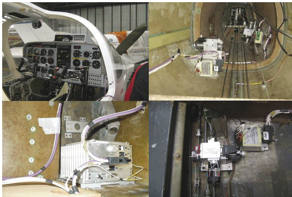
Rys. 3. Wnętrze samolotu I-23 po modernizacji dla systemu FRF
