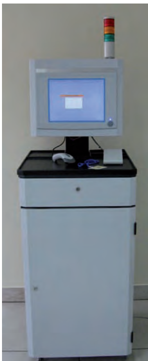
Rys. 1. Prototypowe mobilne stanowisko monitorowania maszyn i operatorów (za zgodą Bernacki Industrial Services Sp. z o.o.)
