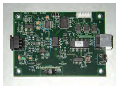
Rys. 7. Wnętrze jednostki kontrolnej OCZ NIA
