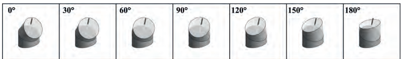
Rys. 5. Dolny (ciemnoszary) moduł jest przymocowany do podstawy i nie obraca się. Oś obrotu, która jest prostopadła do dolnej powierzchni górnego modułu, jest zaznaczona na ciemnoszaro
