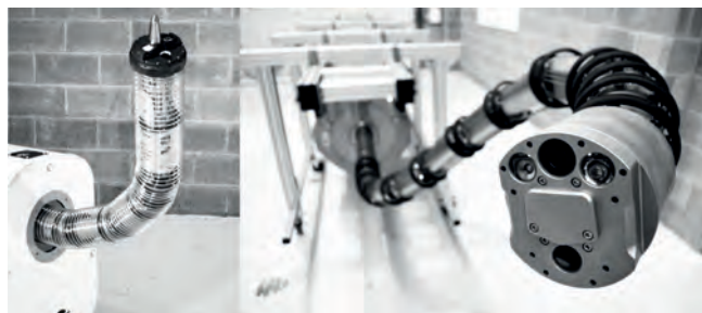
Rys. 2: Oliver Crispin Robotics Ltd. Manipulatory bioniczne z serii II, systemu X125. Po lewej: manipulator z laserową głowicą tnącą. Po prawej: manipulator inspekcyjny z lampą i kamerą ( http://www.ocrobotics.com )
